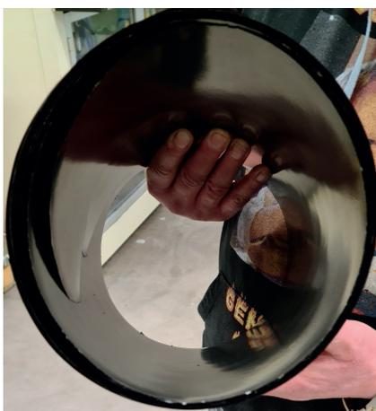
**Bild 1.** Durch die Modifizierung der hochgefüllten Kunststoffe sind deutlich dünnere Bipolarplattenfolien möglich, als das bisher der Fall war © Eisenhuth
